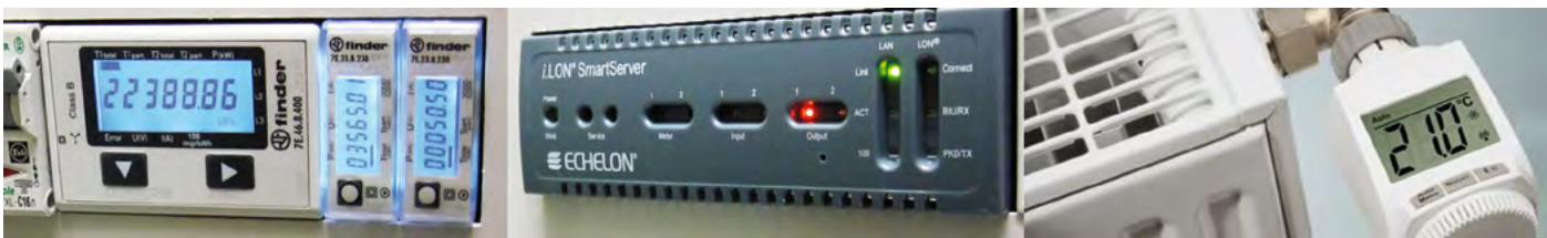
SmartMeter, SubMeter und Controller ermöglichen die Erfassung und Steuerung der Verbräuche
